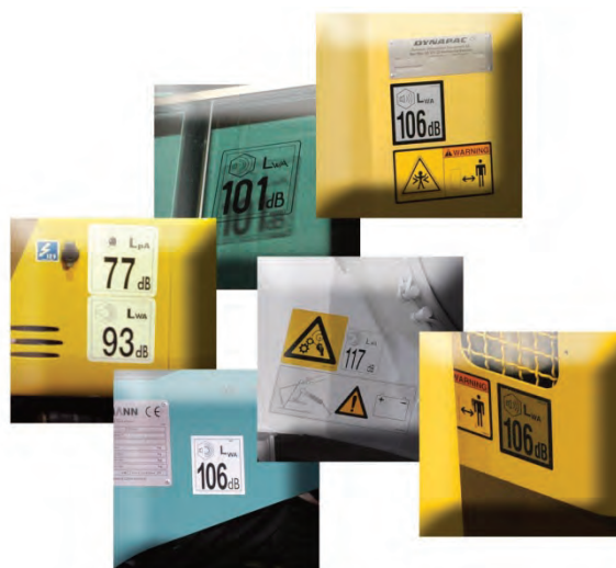
FIGURA 17 - TARGHETTE RIPORTANTI IL LIVELLO DI POTENZA SONORA PER UNA MACCHINA O ATTREZZATURA RISPONDENTE ALLA 2000/14/CE (SN) E A QUELLA PRECEDENTE NORMATIVA (DX)
